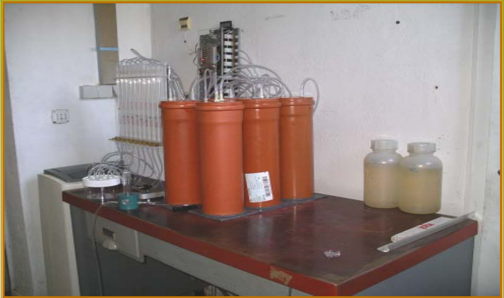
Anlage zur Messung der Spurengasemission (ZALF Müncheberg)
